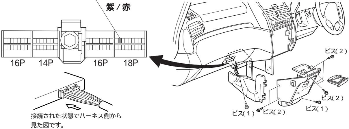
紫 / 赤の線に車速センサー入力コードを接続します。
